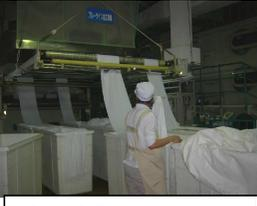
脱水した生地を大きな乾燥機で一気に乾燥させます。
